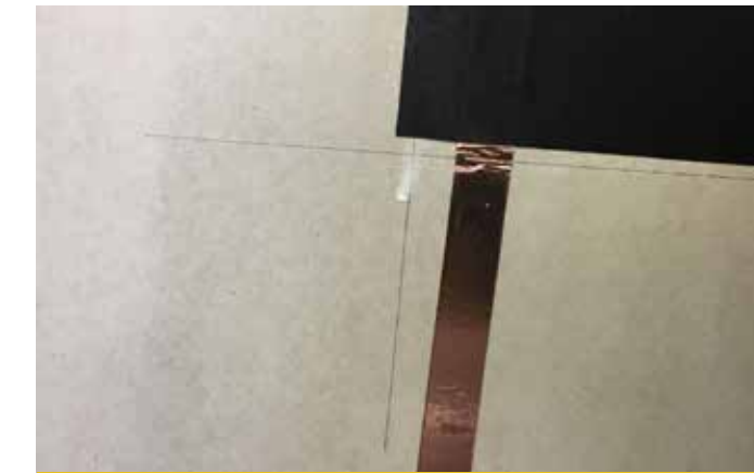
4. Glattstreichen der Elektroden
